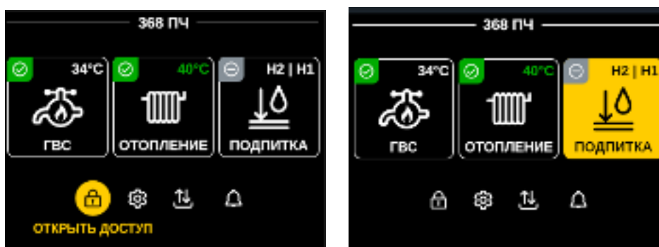
Рис.6. Главный экран ECL4 Control 368R ПЧ с активной навигацией в области модулей автоматики (слева) и в области общего меню (справа).
